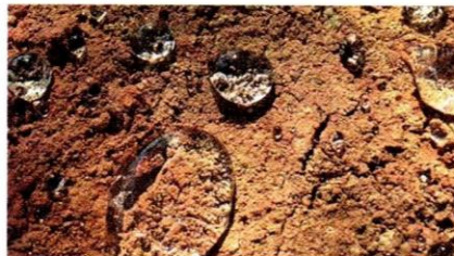
Mithilfe von Nanotol perlt Wasser selbst von porösen Oberflächen einfach ab.
